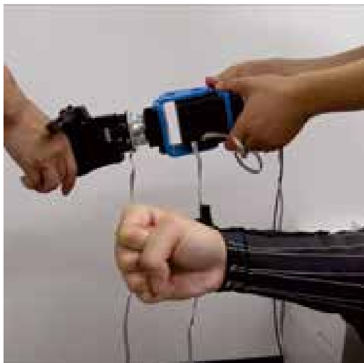
多チャンネル筋電図による義手の操作 Human interface using multichannel EMG signals
