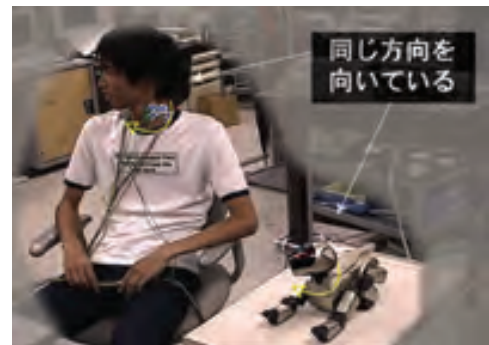
筋電信号を用いたインターフェース：筋肉の活動を示す筋電信号を計測し、仮想世界のロボットや自分の分身を動かすことができる。 Human interface using EMG Signals: EMG signals, which indicate muscle activities, are measured. These signals can bring the robot in the virtual environment or slave of ourselves into action.
