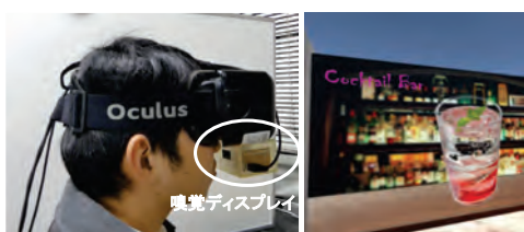
ウェアラブル嗅覚ディスプレイと香るコンテンツ Wearable olfactory display and contents with scents
